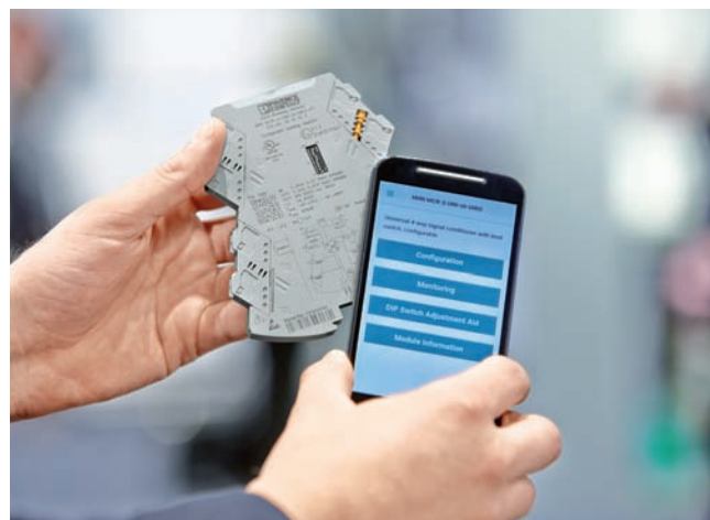
Obr. 2 Mini Analog Pro ponúka spolu s aplikáciou aj rôzne možnosti nastavenia oddeľovačov signálu a komunikačného modulu.
